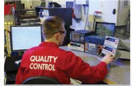
Test final du facteur de marche, sécurité électrique, EMC & CE
