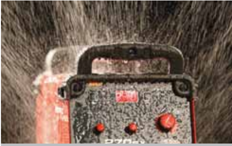
Tests Pluie (Pluie simulée par 70 jets)
